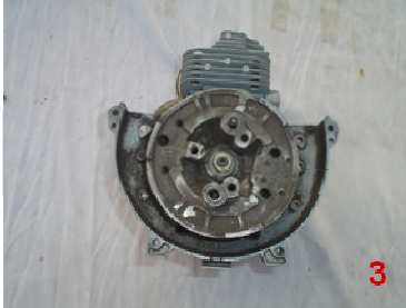
การถอดมูเล่ ด้วยเครื่องมือ 3 ขา มูเล่จะแตกเสียหาย
