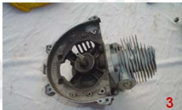
การถอดมูเล่ ด้วยเครื่องมือแบบประดิษฐ์เอง
