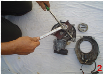
การถอดมูเล่ ด้วยเครื่องมือ 3 ขา มูเล่จะแตกเสียหาย
