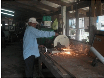
ภาพที่ 6 เตรียมวัสดุประกอบแทนติดตั้งมอเตอร์
