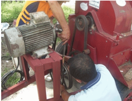
ภาพที่ 12 ติดตั้งสายพาน
